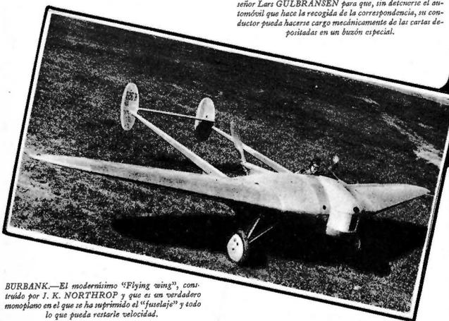
BURBANK.—El modernísimo "Flying wing", construido por J. K. NORTHROP y que es un verdadero monoplano en el que se ha suprimido el "fuselaje" y todo lo que pueda restarle velocidad.
